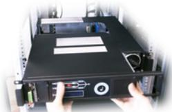
Retirer les vis la gauche / droite et faites glisser le boîtier
