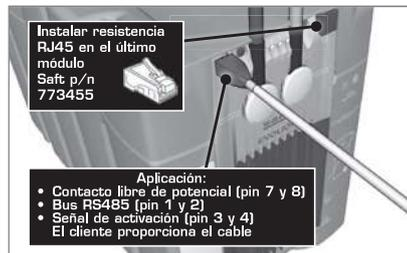
Figura 7: Conexión de la Comunicación con un módulo
